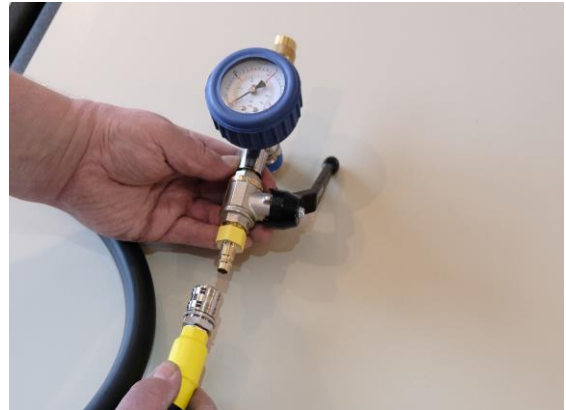
2. Kuppeln Sie den Vordruckschlauch an den Stecknippel (gelb) der Sicherheitsarmatur und verriegeln Sie die Verbindung. Beachten Sie, dass der Kugelhahn quer zur Fließrichtung steht
