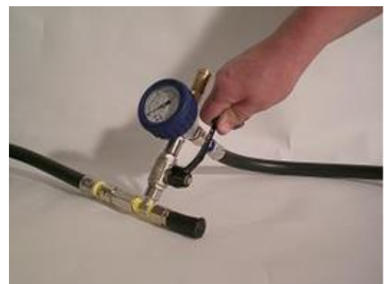
6. Öffnen Sie langsam den Kugelhahn der Sicherheitsarmatur.
