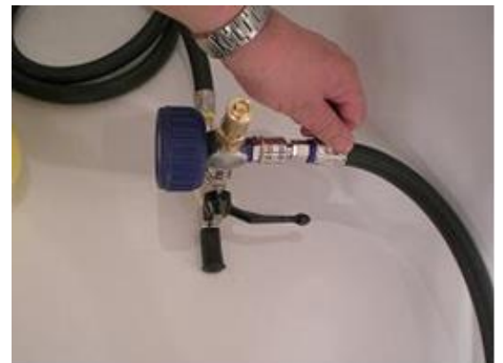
4. Die andere Seite des Füllschlauches (Stecknippel) verbinden Sie mit der blau gekennzeichneten Kupplung an der Unterseite der Sicherheitsarmatur und verriegeln diese
