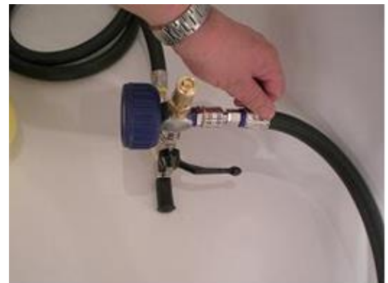
4. Die andere Seite des Füllschlauchs (Stecknippel) verbinden Sie mit der blau gekennzeichneten Kupplung an der Unterseite der Sicherheitsarmatur und verriegeln diese
