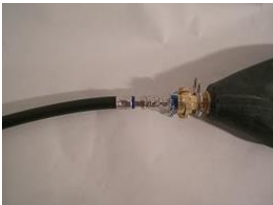
3. Kuppeln Sie die blau gekennzeichnete Kupplung des Füllschlauchs an den Stecknippel des Kanaldichtkissens und verriegeln Sie die Verbindung mit der Schraubbringsicherung
