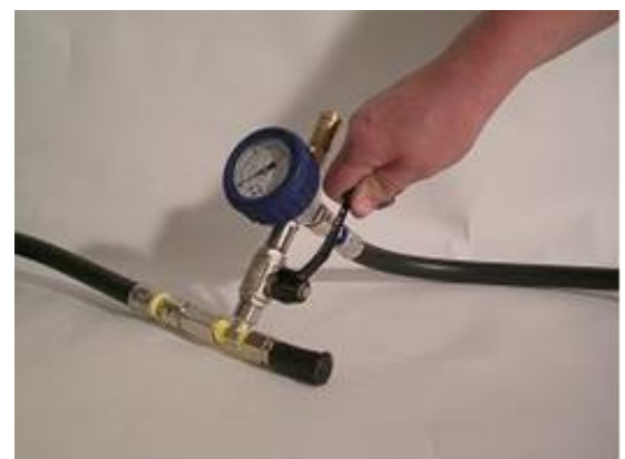
6. Öffnen Sie langsam den Kugelhahn der Sicherheitsarmatur.
